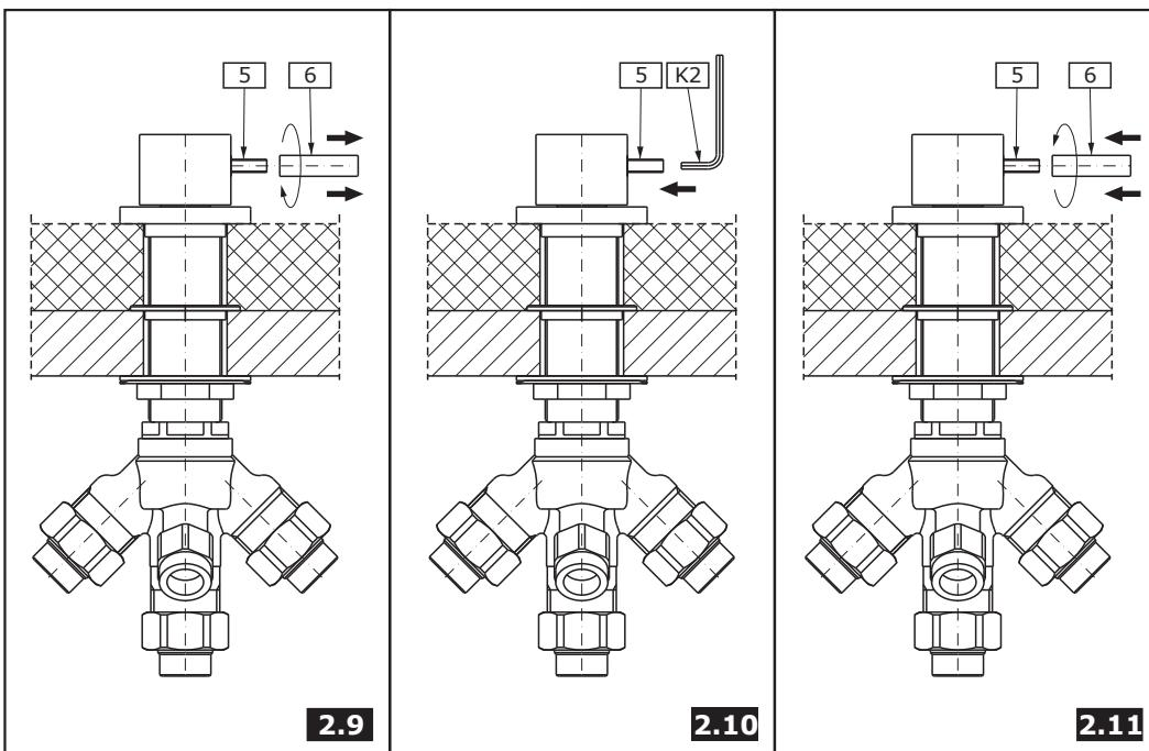
**DIVERTER VALVE TRIM INSTALLATION • INSTALACIÓN EL ACABADO DE LA VÁLVULA DE DESVIADOR**
