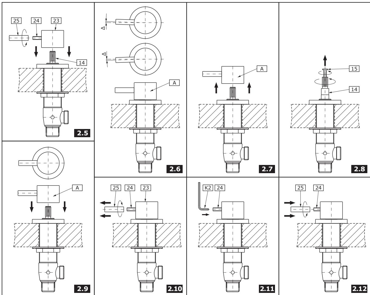
**INSTALLATION OF THE SPOUT • MONTAJE DE CAÑO**
